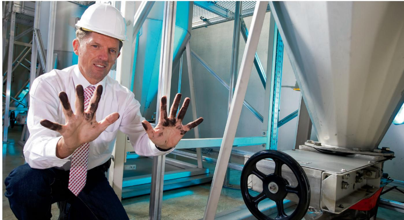
Wertvoller Schmutz: KIT-Chemiker Ralph Stahl demonstriert, was nach einer Pyrolyse von Biomasse im Sammelbehälter landet – Koks. Das feine Kohlenstoff-Pulver wird mit einem öligen Kondensat zu „Bioslurry“ vermischt. Sowohl das flüssige Öl als auch der feste Koks entstehen beim Verschmoren von pflanzlichem Kohlenstoff per Pyrolyse. Pro Stunde kann die Karlsruher Pilotanlage bis zu eine halbe Tonne Biomasse verarbeiten.
