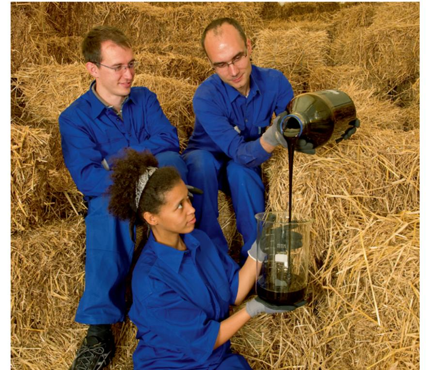
Schwarzes Gold aus trockenen Halmen: Zäh wie Honig ist der Bioslurry, der bei der Pyrolyse von Stroh oder Holzabfällen entsteht. Der Clou der sämigen Brühe: Mit ihr lässt sich die dezentral aus Pflanzenmaterialien extrahierte Energie bequem zu einer zentralen Syntheseanlage transportieren – wo sich daraus etwa Dieselmotoren, Kerosin oder Grundstoffe für die chemische Industrie gewinnen lassen.
