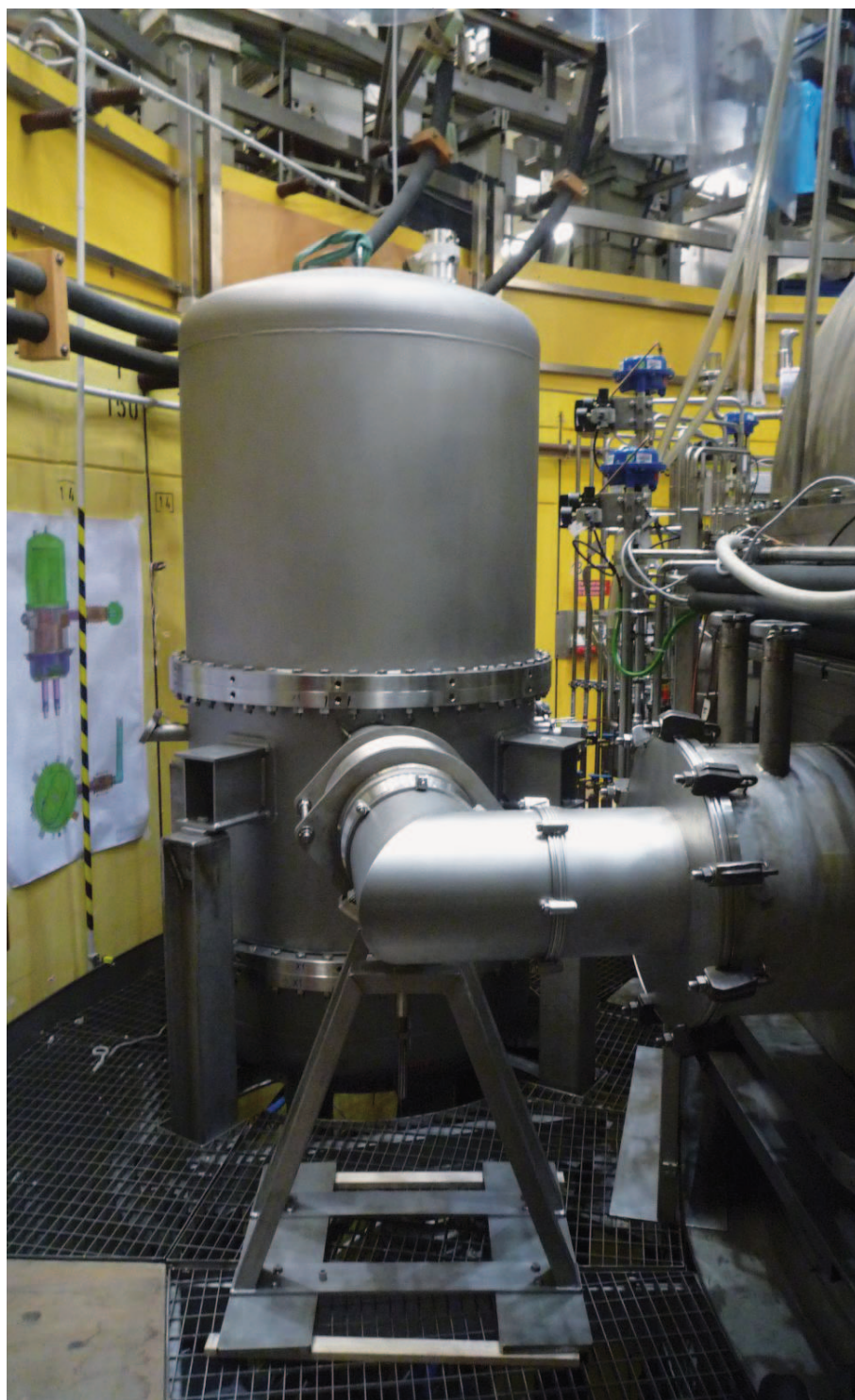
Der Testkryostat, angeschlossen an den Hauptvakuumkessel der Anlage TOSKA am KIT.
