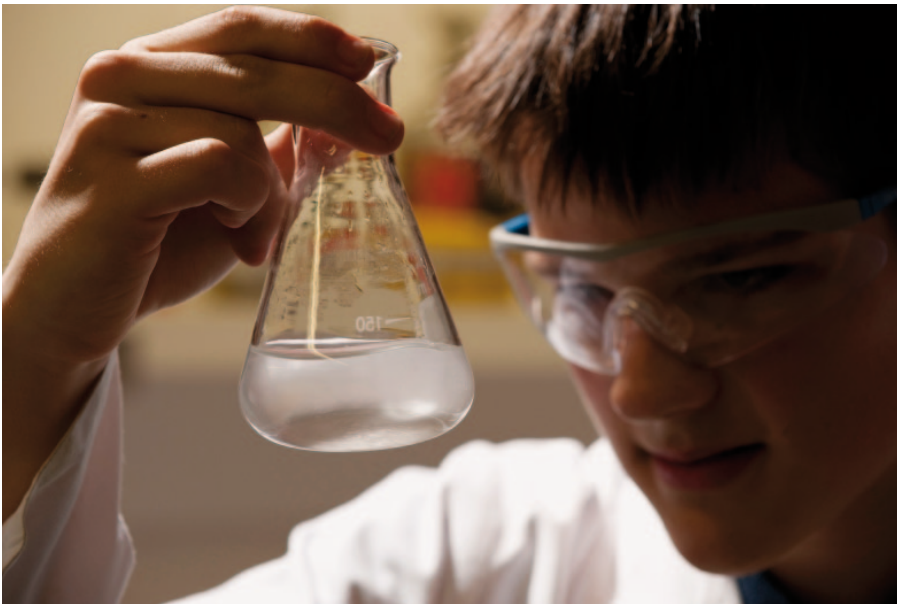
Niederschlagsbildung von Bariumsulfat zur Simulation einer realen Sole.
