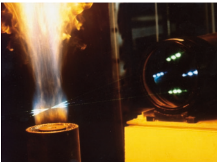
Abbildung 3: Laserdiagnostik zur Untersuchung turbulenter Drallflammen.
