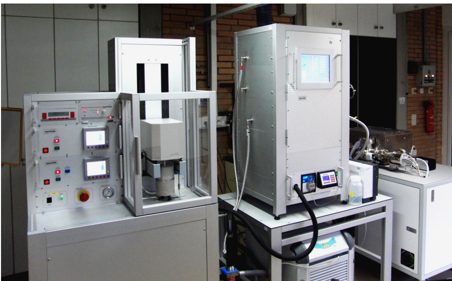
Magnetschwebewaage zur Hochdruck-Thermogravimetrie. Die einzigartige Anlage ermöglicht es, den Druckeinfluss auf die Vergasungskinetik fester Brennstoffe zu quantifizieren.
